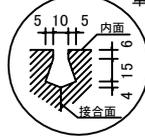
電柱よけ施工図
